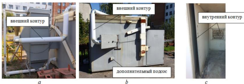
Рисунок 1 - Модульная сушилка аэродинамического нагрева: а, б – внешний контур рециркуляции; с- внутренний контур рециркуляции
